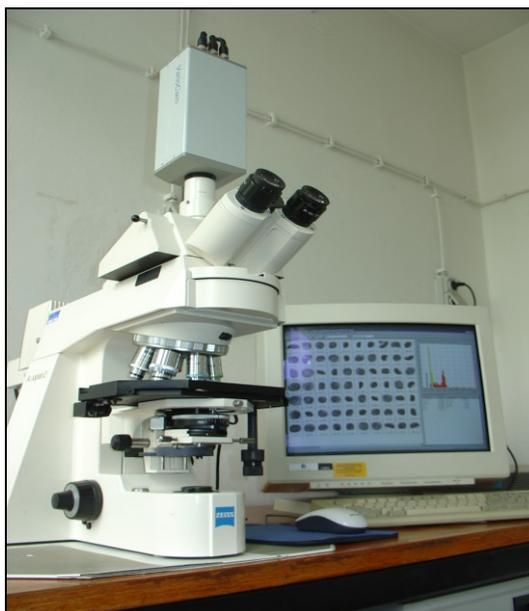
**Abb. 6:** Zeiss Axioplan 2 Mikroskop mit Schwarzweisskamera und der AutoCyte Quic-DNA-Workstation Software.
